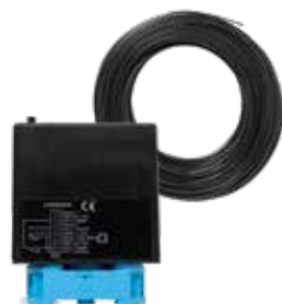
Induksjonssløyfe Induksjonssløyfedetektor med lukkekontakt og vekselkontakt, innstillbar på impuls- og permanent kontakt, retningsregistrering, 50 m sløyfekabel
