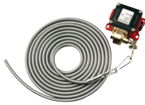
Snortrekkbryter med snor i kunststoff Montering horisontalt eller vertikalt mulig, formstøpt aluminiumsboks, IP 65, kabellengde 4 m
