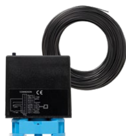
Induksjonssløyfe Induksjonssløyfedetektor med lukkekontakt og vekselkontakt, innstillbar på impuls- og permanent kontakt, retningsregistrering, 50 m sløyfekabel
