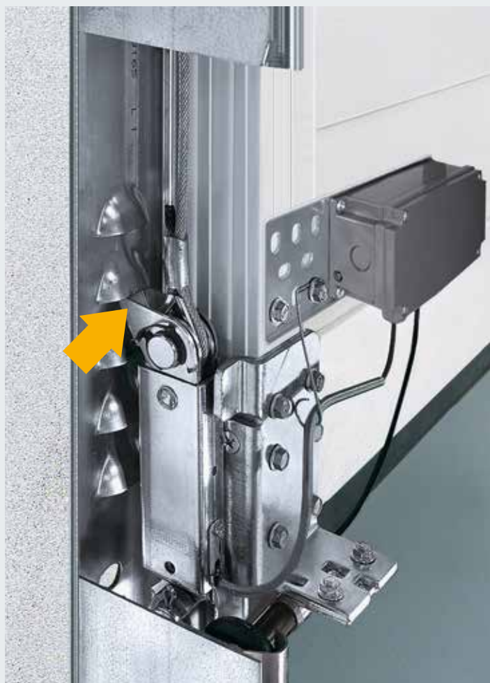
Låsekroken på innbruddsikringen smekker automatisk på plass når porten løftes opp.
