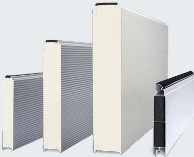
Sandwich-seksjoner i stål med brutt kuldebro i tre tykkelser: 42, 67 og 100 mm, Acoustic-seksjon
