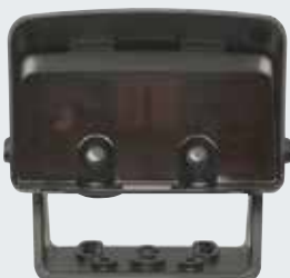
Radar-bevegelsesdetektor MWD-C Hurtig og målrettet automatisk portåpning, retningsregistrering, maks. monteringshøyde 7 m, montering i fryserom mulig inntil maks. -22 °C, kapslingsgrad IP 65
